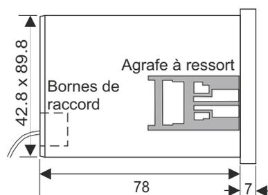
**Référence à la commande:** DM6.100 Module afficheur pour Profibus
