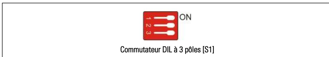
Le commutateur DIL [S1] permet le réglage de l'état d'appareil :
