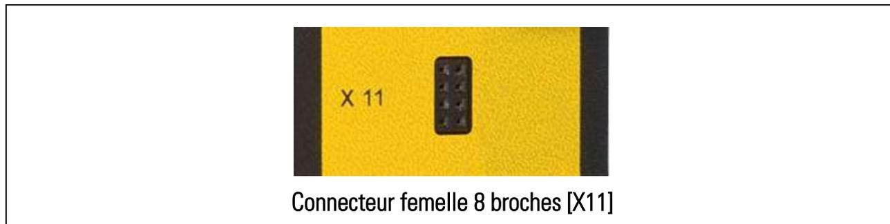
La communication entre l'unité de commande BG250 et le contrôleur de sécurité est assurée par le branchement de l'unité de commande sur le connecteur femelle 8 broches [X11].
